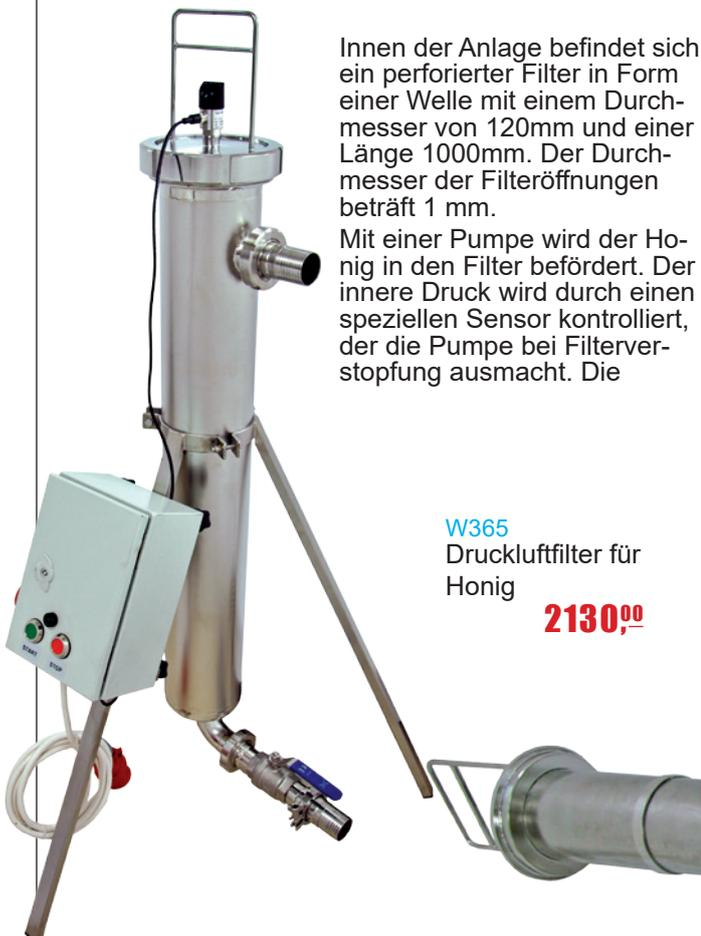
Innen der Anlage befindet sich ein perforierter Filter in Form einer Welle mit einem Durchmesser von 120mm und einer Länge 1000mm. Der Durchmesser der Filteröffnungen beträgt 1 mm.
