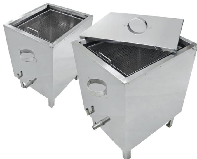
Sie eignet sich zur Wiedergewinnung von Wachs aus den Rähmchen oder nur des trockenen Wachses im Dampfverfahren. Das Gerät besteht aus einem Außenbehälter mit Wasser und aus einem Korb zum Mischen der Rähmchen oder des trockenen Wachses. Dieses Modell hat wärmeisolierte Seitenwände, was Wärmeverluste ausschließt.
