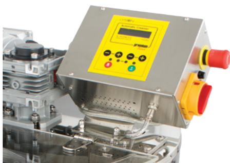
Die Steuerung des Honigrührgerätes der PREMIUM Linie verfügt über ein eingebautes Programm, in dem das zyklische Ein- und Ausschalten eingestellt werden kann (im Menü kann man das manuell einstellen).
