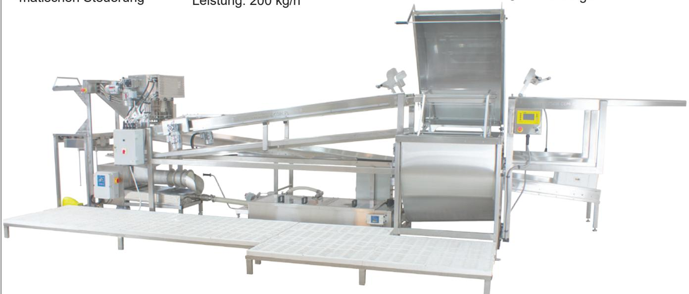
**A A1 Der pneumatische Rahmenwerfer verbunden mit einer Kettenzuführung**
